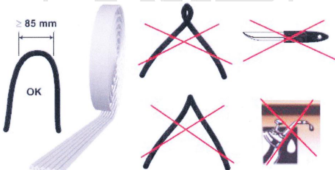
Obr. 11 – Zakázané operace s nosnými polyuretanovými pasy
